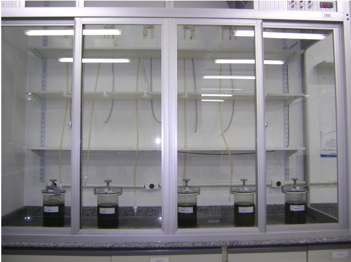
Figura 1. Biorreatores anaeróbios alimentados com dejetos suínos tratados com duas marcas comerciais de biodegradadores naturais distintas por 90 dias.
