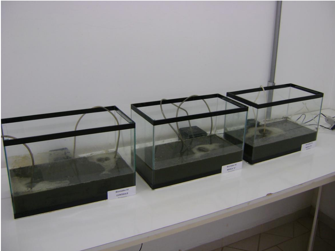
Figura 2. Biorreatores aeróbios alimentados com dejetos suínos tratados com duas marcas comerciais de biodegradadores naturais distintas por 30 dias.
