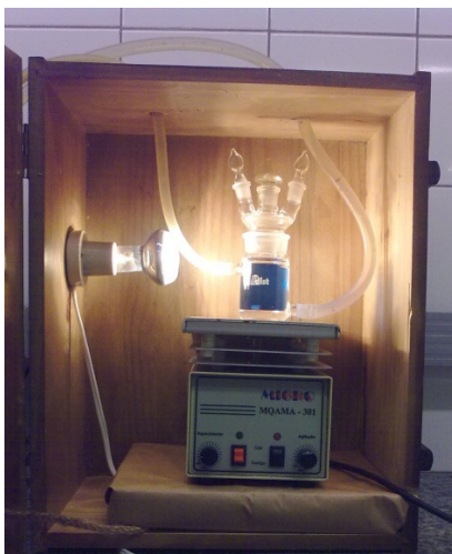
Figura 3 - Sistema adaptado para a realização dos testes com diferentes fontes de luminosidade.
