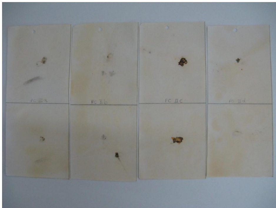
Figura 22 – Amostras PC IIb, IIc e IId tratadas com a solução de clorexidina 2% após o envelhecimento artificial. A amostra PC IIa é a não envelhecida, 2012.
