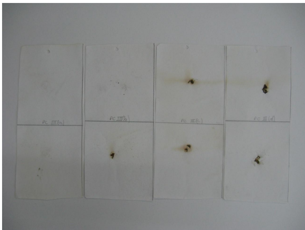
Figura 25 – Amostras PC IIIb, IIIc e III d tratadas com a solução de água + álcool após o envelhecimento artificial. A amostra PC IIIa é a não envelhecida, 2012.
