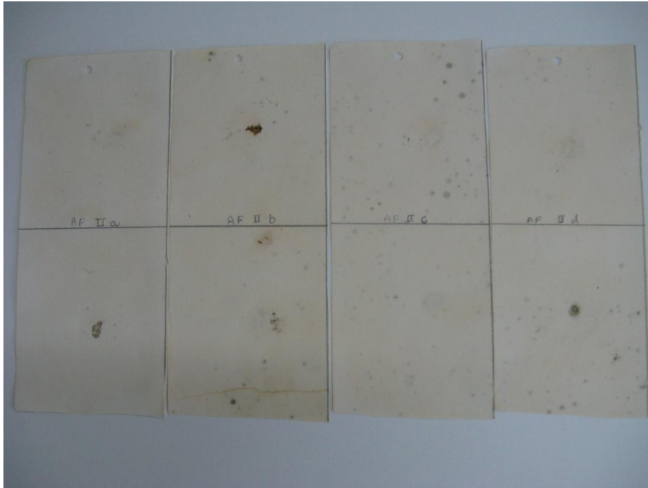
Figura 21 – Amostras AF IIb, IIc e IId tratadas com a solução de clorexidina 2% após o envelhecimento artificial. A amostra AF IIa é a não envelhecida, 2012.
