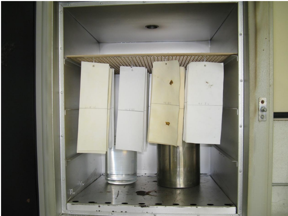
Figura 14 – Imagem das amostras na câmara simulada de envelhecimento artificial, julho de 2012.
