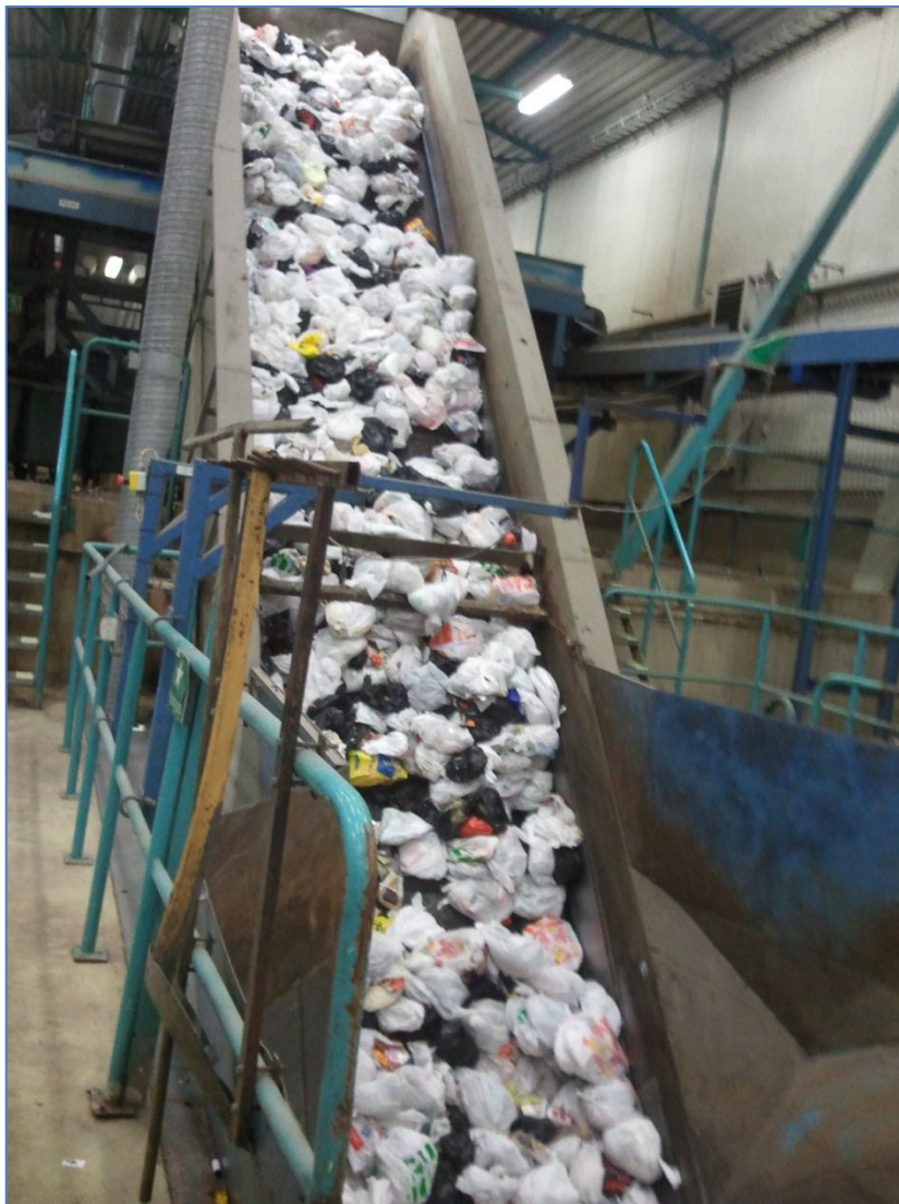
Figura 35 - Fluxo de resíduos a serem classificados opticamente
