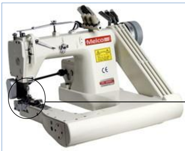
Figura 4 – Máquina Fechadeira de Braço e Dispositivo auxiliar
