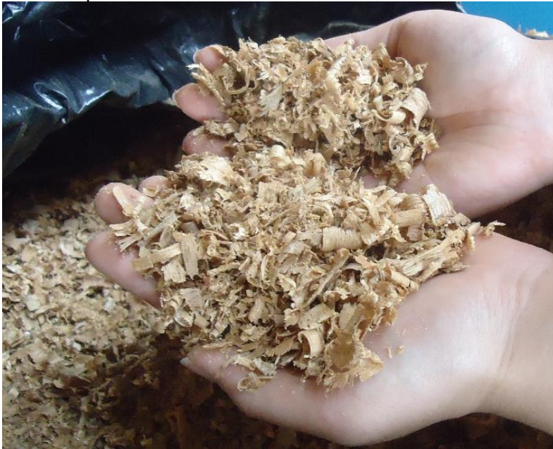
Figura 8 - Partículas de espécie tropical utilizadas na produção dos painéis.
