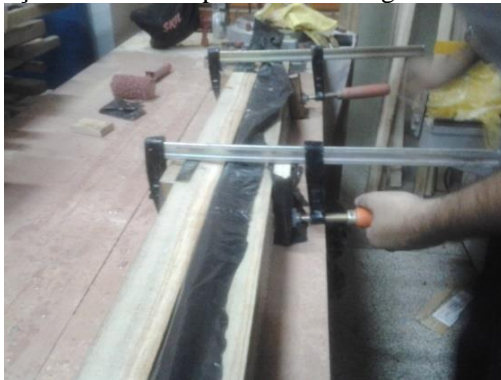
Figura 11 - Junção das laminas para formar a viga com contenção lateral
