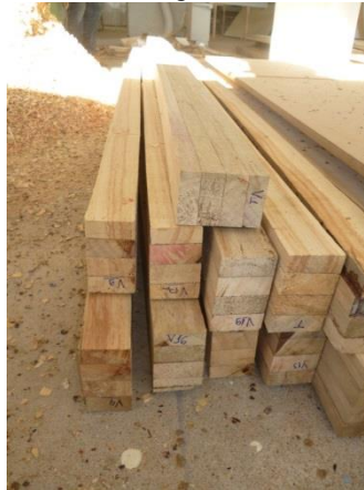
Figura 15 - Produto final acabado: vigas de MLC de Paricá
