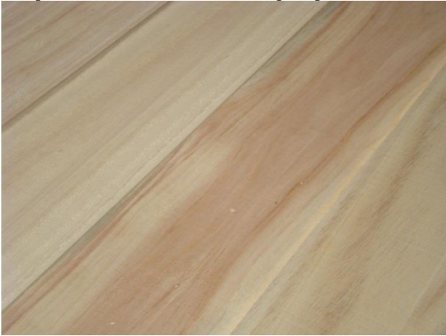
Figura 3: Aspecto final da lâmina de Paricá após aplainamento
