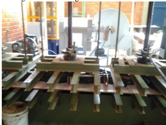
Figura 12 - Prensagem a frio das vigas
