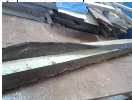
Figura 13 - Viga após a cura do adesivo em prensa à frio
