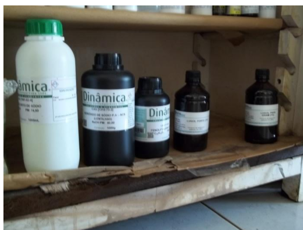
Fotografia 13: Prateleiras inadequadas ao armazenamento de produtos químicos. Fonte: E. E. B. Presidente Artur da costa e Silva (2013).
