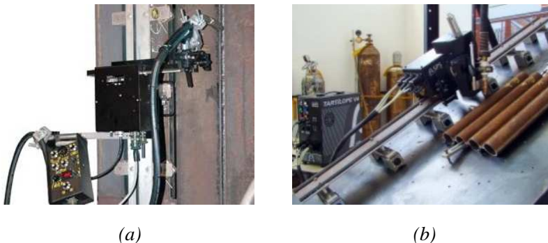
Figura 3 Manipuladores de Soldagem: em (a) Universal Bug-O-Matic [9]; em (b) Tartilope V4 [14]
