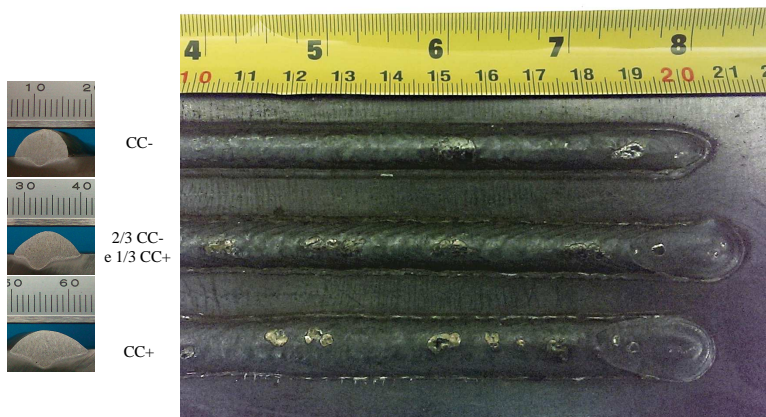
Figura 60 Macrografias e visão superior dos cordões de solda obtidos ao variar a polaridade no eletrodo
