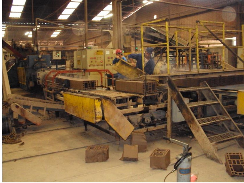
Figura 8- Maromba, máquina que faz a produção do tijolo
