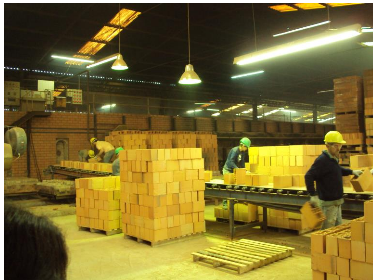
Figura 9- Seleção da qualidade e empilhamento dos tijolos nos Palets
