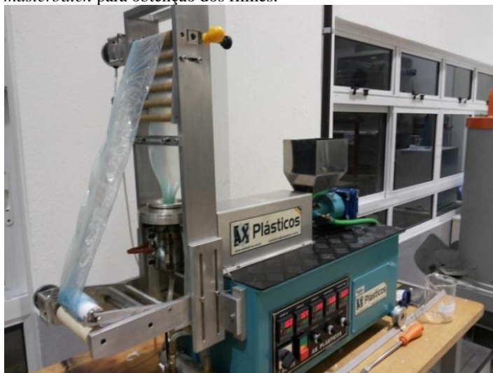
Figura 20 – Extrusora de bancada, tipo monorosca, durante processamento do masterbatch para obtenção dos filmes.
