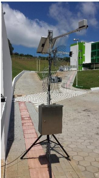
**Figura 27 - PCD montada no tripé**
