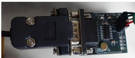
**Figura 23 - Módulo conversor TTL-RS232**
