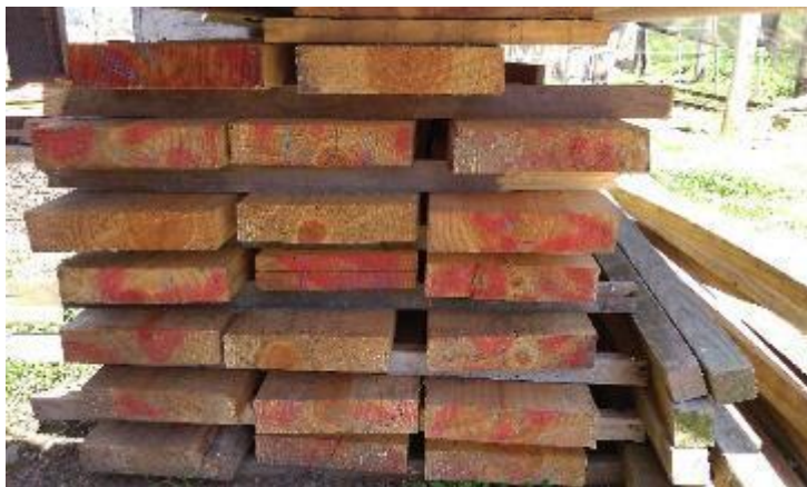
Figura 7. Secagem das tábuas ao ar livre.
