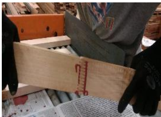
Figura 13. União manual de topo.
