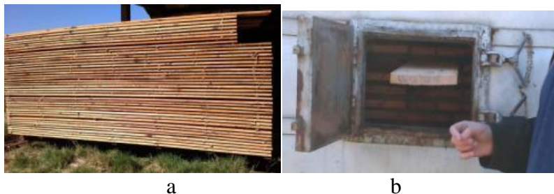
Figura 8. Secagem: a) ao ar livre; b) em estufa.
