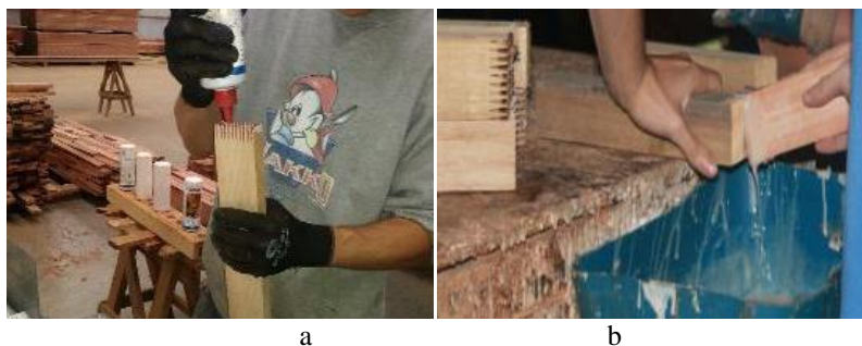
Figura 12. a) Aplicação do adesivo resorcinol; b) Aplicação da melamina.
