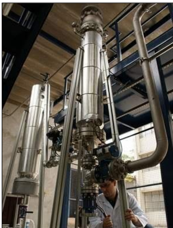
Figura 5: Reator de explosão a vapor, IPT SP.
