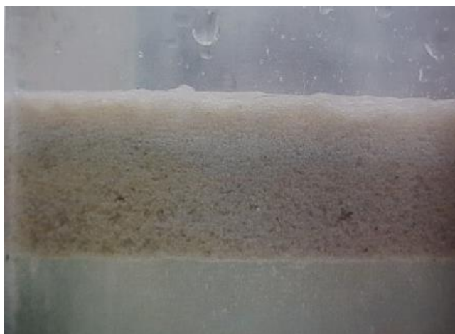
Figura 5 - Lodo formado durante a eletroflotação.
