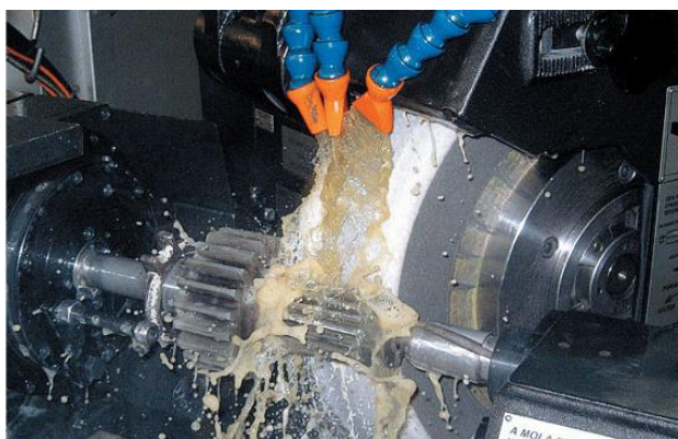
Figura 1 - Usinagem de peça com uso de fluido de corte.
