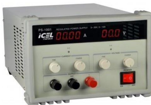
Figura 12 - Unidade retificadora de corrente utilizada nos ensaios de eletroflotação de bancada.
