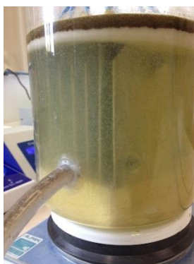
Figura 17 - Efluente da indústria metalmecânica após eletroflotação com pH inicial igual a 2,0.
