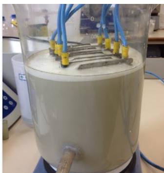
Figura 16 - Efluente da indústria metalmecânica após eletroflotação com pH inicial igual a 7,2.
