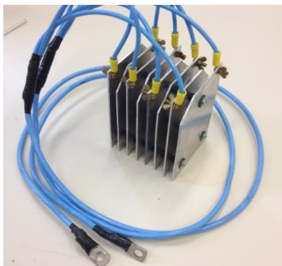
Figura 11 - Conjunto monopolar de eletrodos de alumínio utilizado nos ensaios de eletroflotação - arranjo em paralelo.
