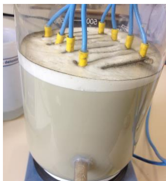
Figura 15 - Efluente da indústria metalmeccânica após eletroflotação com pH inicial igual a 9,9.
