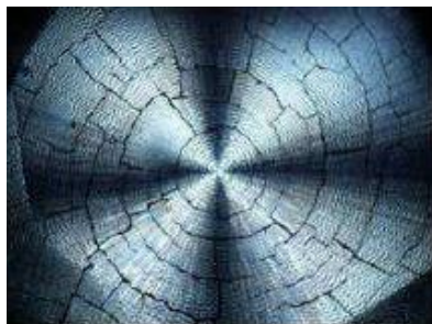
Figura 8 - Esferulito de PHB observado em um microscópio óptico com luz polarizada
