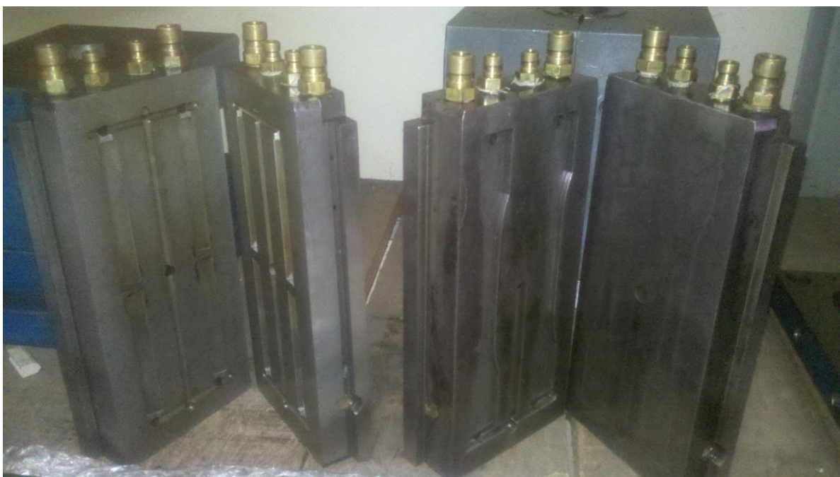
Figura 28 - Cavidades do molde de injeção para os corpos de prova de tração de impacto
