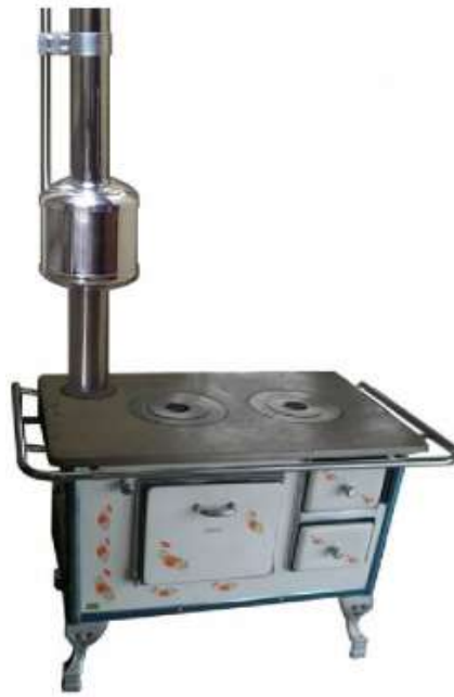
Figura 7 - Recuperador de calor, modificado, instalado acima da câmara de combustão do fogão a lenha.
