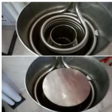
Figura 5 – Vista em corte da chaminé, explicitando o sistema espiralado e a tampa de reversão dos gases.
