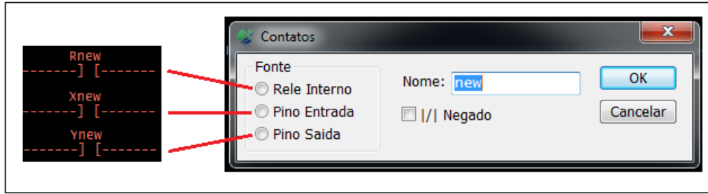
Figura 14 - Seleção de tipos de contatos NA
