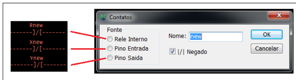
Figura 15 - Seleção de tipos de contatos NF
