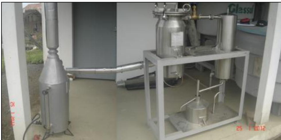
FIGURA 11 - Equipamento piloto para extração de óleo essencial por arraste a vapor
