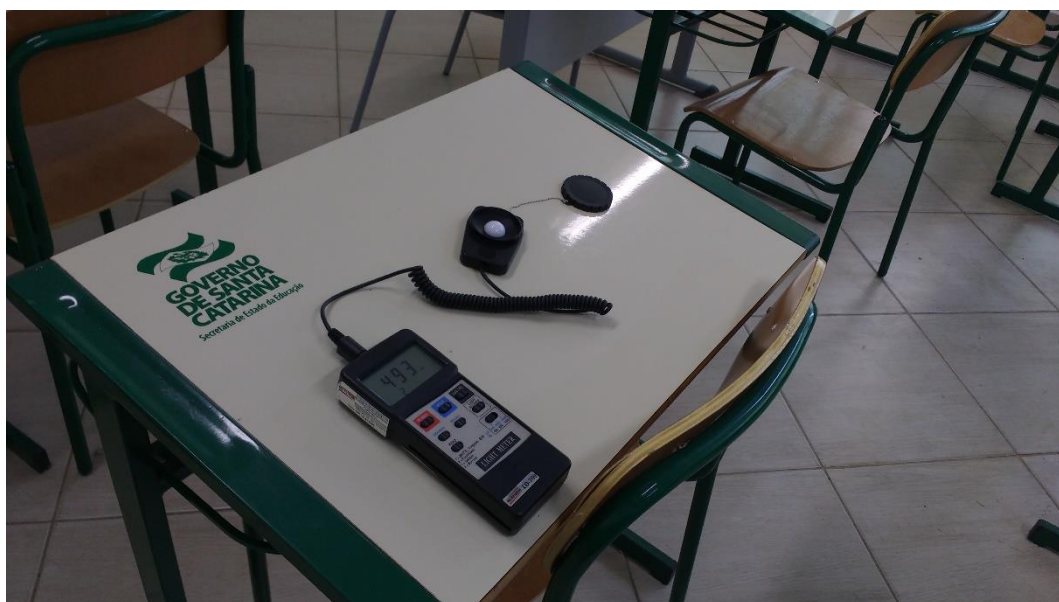
Foto 3: Mensuração do nível de iluminação no tampo da mesa. Fonte: o autor, 2017.
