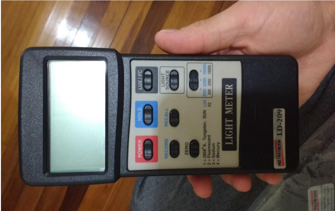
Foto 4: Luxímetro utilizado para medir o nível de iluminamento das salas de aula. Fonte: o autor, 2017.
