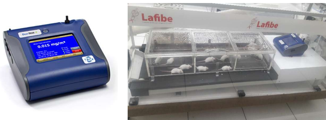
Figura 5- Posição do monitor DustTrack DRX no interior da caixa para inalação de poluentes
